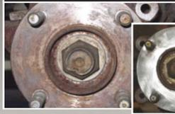
**UZROK:** Korozija nastala na rubovima glavčine što je rezultiralo pretjerano trošenje (0,1mm max) na novom disku
