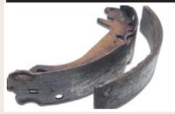
**UZROK:** Blokirana kočnica uslijed ulaza vode, blokirani dijelovi/sajla ili curenje iz kočionog cilindra.
