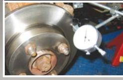
**UZROK:** Tolerancija trošenja nije izmjerena ili postignuta na ugrađenim novim diskovima
