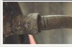
**UZROK:** Gumeno crijevo se potrošilo (propalo) ili onečistilo. Istrošenost (zamor materijala) uslijed nepravilne ugradnje
