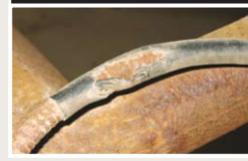
**UZROK:** Ulaz vode u sajlu ručne kočnice uslijed trošenja vanjske obloge
