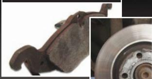
**UZROK:** Ravnomjerno trošenje, kočnice ispravno funkcioniraju. Pločice-preporučuje se zamjena kod 3mm debljine tarnog materijala. Diskovi-provjertiti specifikaciju proizvođača
