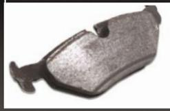
**UZROK:** Nove pločice ugrađene na istrošenim diskovima
