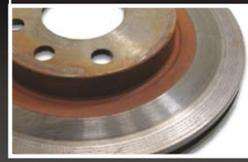
**UZROK:** Veoma istrošene pločice, prljavština ili krhotine između pločice i diska, blokirana čeljust
