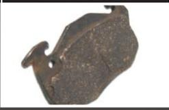
**UZROK:** Neradovito održavanje ili blokada dijelova, neravnomjerno ili pretjerano trošenje tarnog materijala
