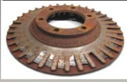
**UZROK:** Pločice i /ili diskovi predugo korišteni prije zamjene
