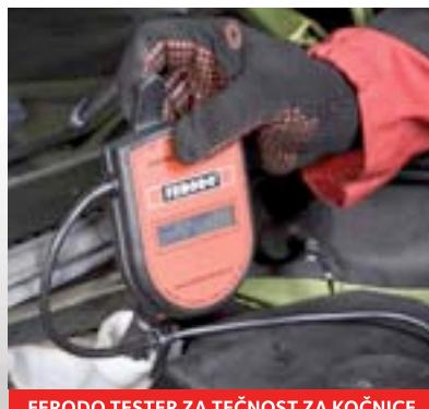
FERODO TESTER ZA TEČNOST ZA KOČNICE
